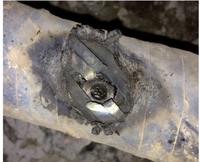
Störfall: Beschädigtes Mittelspannungskabel 20kV
